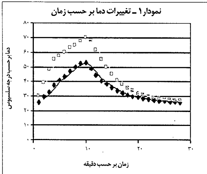
نمودار مربوط به آزمایش اول: منحنی مربوط به لوله سیاه منحنی مربوط به لوله سفید
