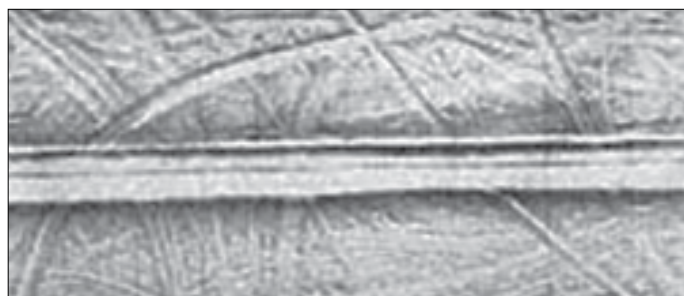
شکل ۴. تصویر بستر دریای بیفورت که آثار تخریب ناشی از حرکت کوه‌های یخی روی آن مشخص است.
