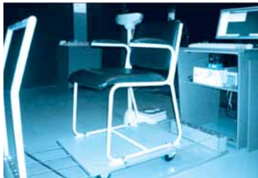
شکل ۲: ترتیب آزمایش برای اندازه‌گیری جرم لختی یک شخص
