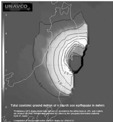
تصویر ۵. نقشه نشان‌دهنده حرکت کلی زمین ناشی از رویداد زمین‌لرزه سندای منحنی‌ها میزان حرکت زمین را به متر نشان می‌دهد. این نقشه توسط پژوهشگران آمریکا و ژاپنی تهیه شده است.
