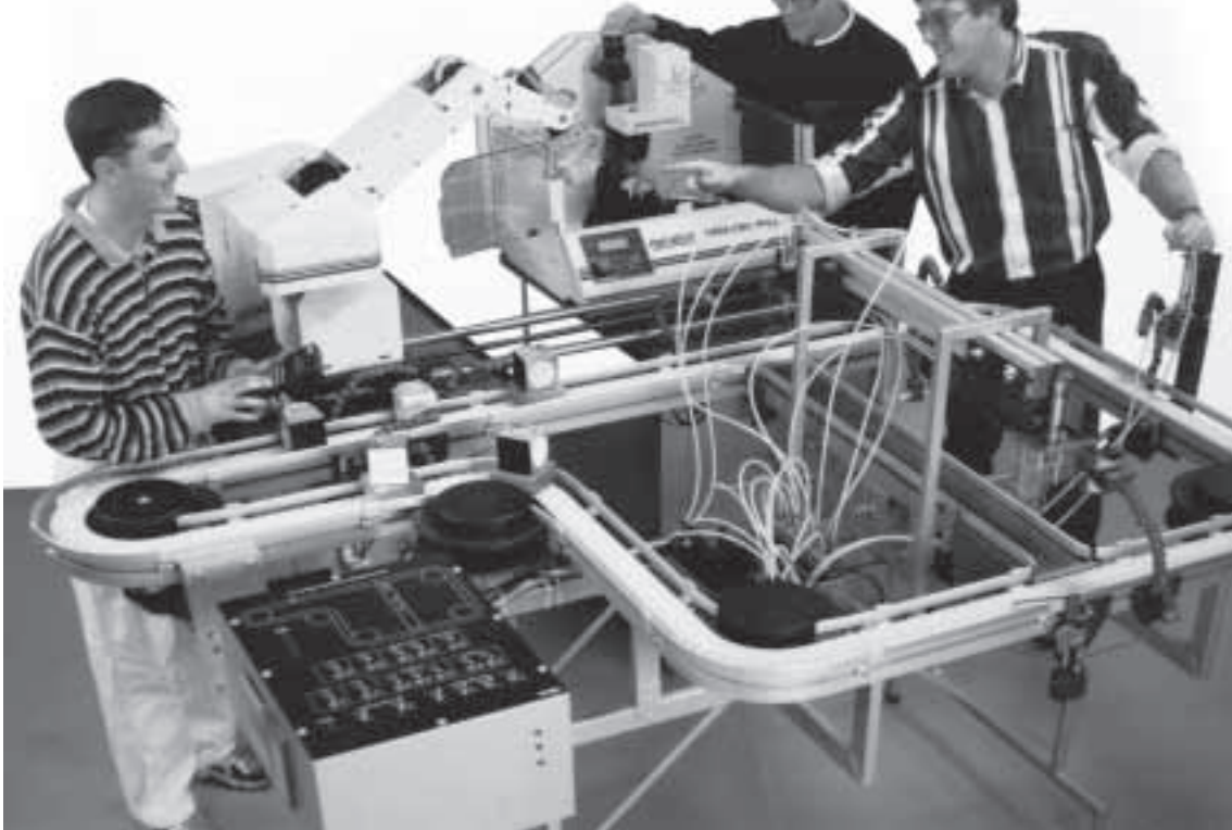
شبیه‌ساز (سیمولاتور) سخت‌افزاری خط تولید در کارخانه
