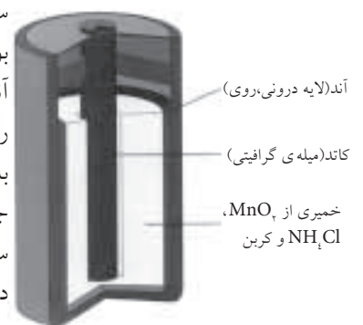
نمای درونی باتری روی-کربن
