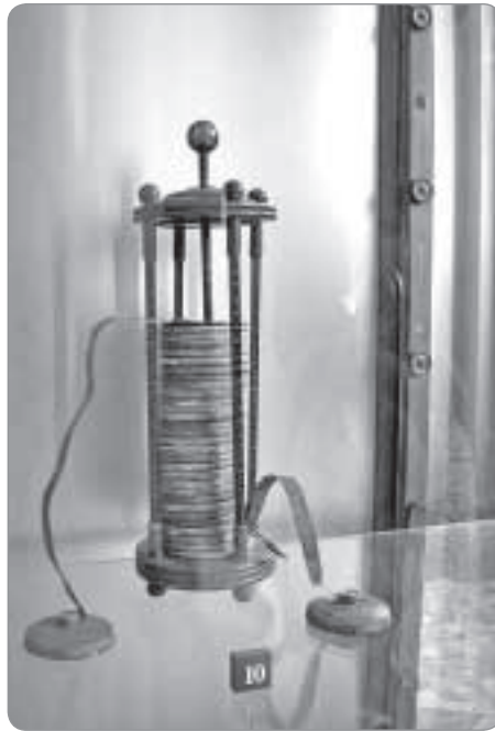
آلساندرو ولتا، در باتری خود صفحه‌هایی از روی و نقره (یا مس) را یکی پس از دیگری روی هم قرار داد و در فاصله‌ی میان آن‌ها تکه پارچه‌های خیس گذاشت.
