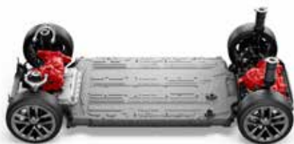
شکل ۷. بسته باتری در کف خودرو قرار داده می‌شود. نیروی وزن ناشی از جرم این بسته باتری (که برای ظرفیت ۱۰۰ کیلووات ساعتی حدود ۶۲۵ کیلوگرم است) سبب می‌شود گرانیگاه (مرکز گرانش) خودرو به سطح زمین نزدیک‌تر شود و از واژگون شدن آن جلوگیری به عمل آید.
