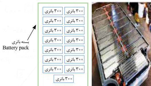
شکل ۶. بسته باتری خودروی ۱۰۰ کیلووات ساعتی که از ۱۵ واحد تشکیل شده است. در هر واحد، ۳۰۰ باتری لیتیم یونی مدل ۱۸۶۵۰ قرار دارد.
