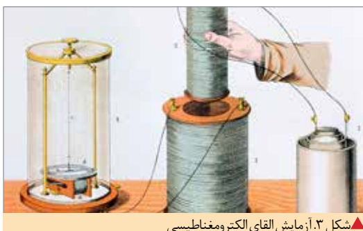
▲ شکل ۳. آزمایش القای الکترومغناطیسی
