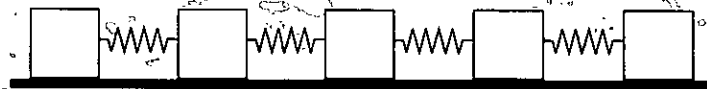
شکل ۱. زنجیره ای متشکل از N قطعه ی یکسان که با N-1 فنر روی یک سطح بدون اصطکاک به هم متصل شده اند.
