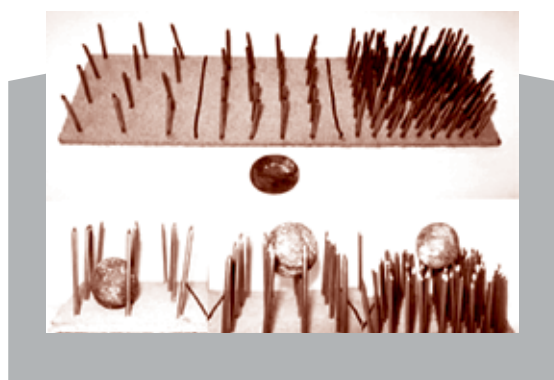
▲ شکل ۱۰ شبیه‌سازی جذب آب در آ. پارچه‌های آبدوست (چپ)، ب. نیمه‌آبدوست (وسط) و پ. آبگریز (راست)
