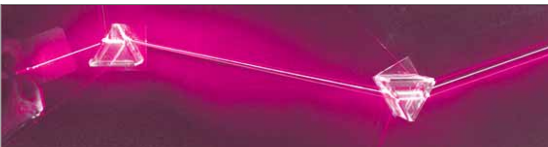
▲ شکل ۵. پرتو نور سفید که از طرف چپ وارد منشور می‌شود، واقعاً از سه پرتو مختلف ساخته شده است (هر کدام از نشانگرهای مختلفی هستند که به‌طور عمودی در کنار یکدیگر قرار گرفته‌اند). هر رنگ به‌صورت متفاوتی به وسیله منشور اول منحرف می‌شود، اما هنگام ترک منشور دوم به‌طور موازی بیرون می‌آیند.
