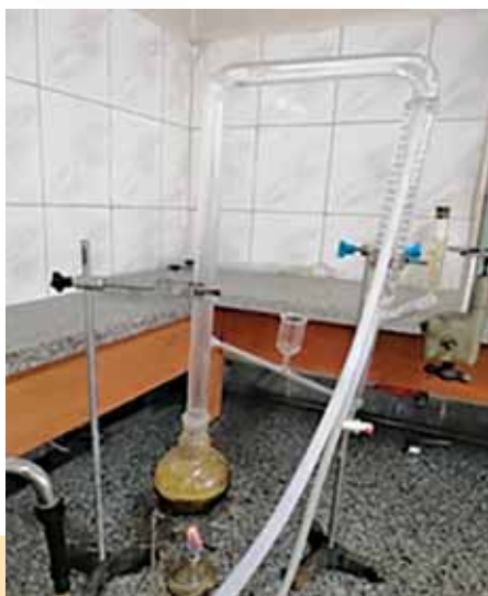
شکل ۱. دستگاه کلونجر اسانس‌گیری از گیاه بومادران
