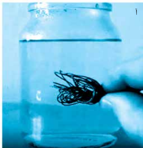
▲ شکل ۱. آ. نمایی از سیم‌های حافظه‌دار مچاله‌شده و ب. بازیابی شکل اولیه سیم‌های حافظه‌دار با فرو بردن آن‌ها در آب گرم.
