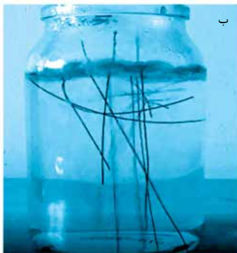
▲ شکل ۱. آ. نمایی از سیم‌های حافظه‌دار مچاله‌شده و ب. بازیابی شکل اولیه سیم‌های حافظه‌دار با فرو بردن آن‌ها در آب گرم.
