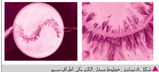
شکل ۸: نمایش خطوط میدان الکتریکی اطراف سیم
