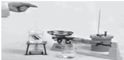
شکل ۱۳. آزمایش اندازه‌گیری گرمای ویژه فلز
