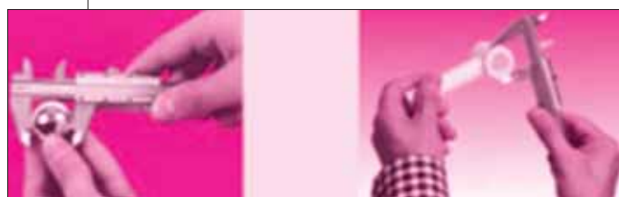
شکل ۲: قسمتی از آزمایش اندازه‌گیری ابعاد لوله
