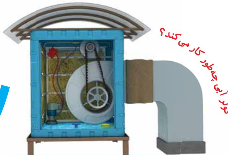
وقتی پمپ آب را روشن می‌کنید، آب روی پوشال‌های کولر می‌ریزد. این آب، گرمای داخل کولر را می‌گیرد و بخار می‌شود. در نتیجه، دمای هوای داخل کولر کم می‌شود. وقتی که کلید روشن را فشار می‌دهید، موتور به کار می‌افتد و هوای خنک داخل کولر را به درون اتاق‌ها می‌فرستد.
