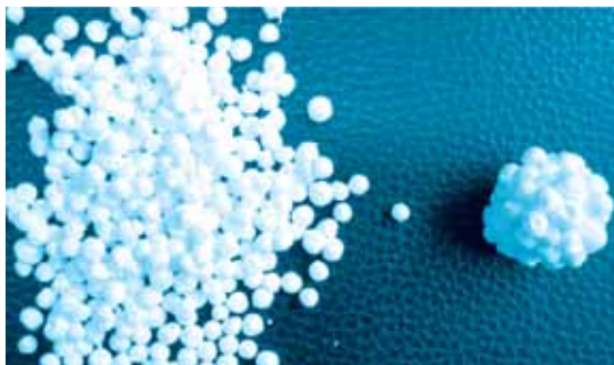
شکل ۳ تهیه توپ با چسباندن دانه‌های پلی‌استیرن به یکدیگر
