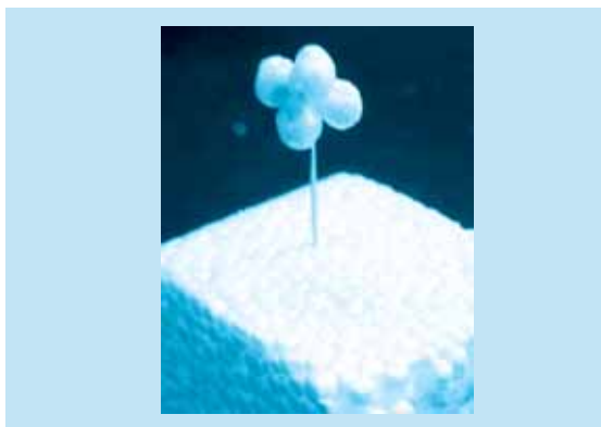
شکل ۲ تشکیل هسته اولیه برای تهیه توپ، با چسباندن دانه‌های جدا شده پلی‌استیرن
