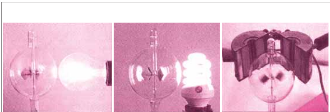
▲ شکل ۱. شکل ۱۰ مقایسه اثر سه منبع امواج الکترومغناطیسی در به چرخش درآوردن پره‌های تابش‌سنج. توان الکتریکی کل لامپ التهابی در حدود ۶۰ وات و توان تابشی کمیته آن ۸۰۰ لومن است، در حالی که توان لامپ فلئورسان فشرده ۱۳ وات و توان تابشی آن ۸۰۰ لومن است. توان کل الکتریکی گرمکن در طرف راست ۶۰ وات است.
