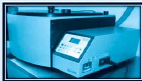
شکل ۲ نمایش از دستگاه ولتامتری برای اندازه‌گیری جیوه
