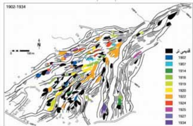
شکل ۱۶. رسوب برجای مانده جریان آواری بر روی مخروط بین سال‌های ۱۹۰۲ و ۱۹۳۴ را نشان می‌دهد. تنها رویدادهایی که بیش از ۶۰۰ متر مکعب از سطح کنونی مخروط را در بر گرفته‌اند روی نقشه نشان داده شده است. رسوبات نشان داده شده به رنگ سیاه سن‌سنجی شده‌اند، اما قدیمی‌تر از مقطع زمانی مورد نظر هستند.
