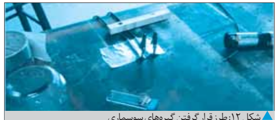
▲ شکل ۱۲: طرز قرار گرفتن گیره‌های سوسماری
