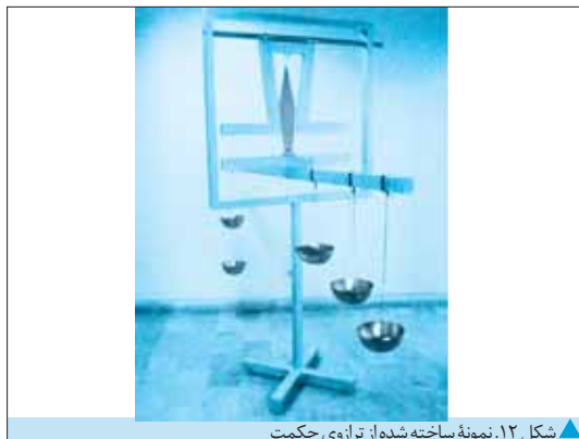
شکل ۱۱. نمونه ساخته شده از ترازوی حکمت
