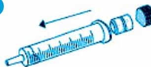
دو آهنربای قوی را در لوله بگذارید و از پیستون لاستیکی به عنوان درپوش استفاده کنید.
