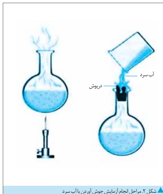
▲ شکل ۲. مراحل انجام آزمایش جوش آوردن با آب سرد
