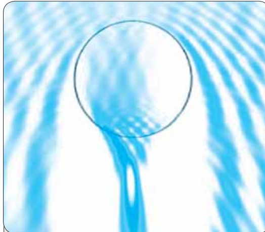
▲ مهندسان حوزه نانو یک نانو روبات کروی از سیلیکا ساخته‌اند که نور را مانند یک عدسی میدان نزدیک کانونی می‌کند تا طرح‌های سطحی را روی ابزارهای در مقیاس نانو بنویسد، در این تصویر نواحی تیره‌تر جاهایی را نشان می‌دهند که در آن‌ها نور تقویت می‌شود تا طرح‌های گودی را روی مواد حساس به نور به وجود آورد.
