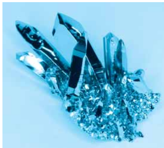
شکل ۱ بلورهای اسمیم که به کمک روش بخار شیمیایی رشد می‌کنند.
