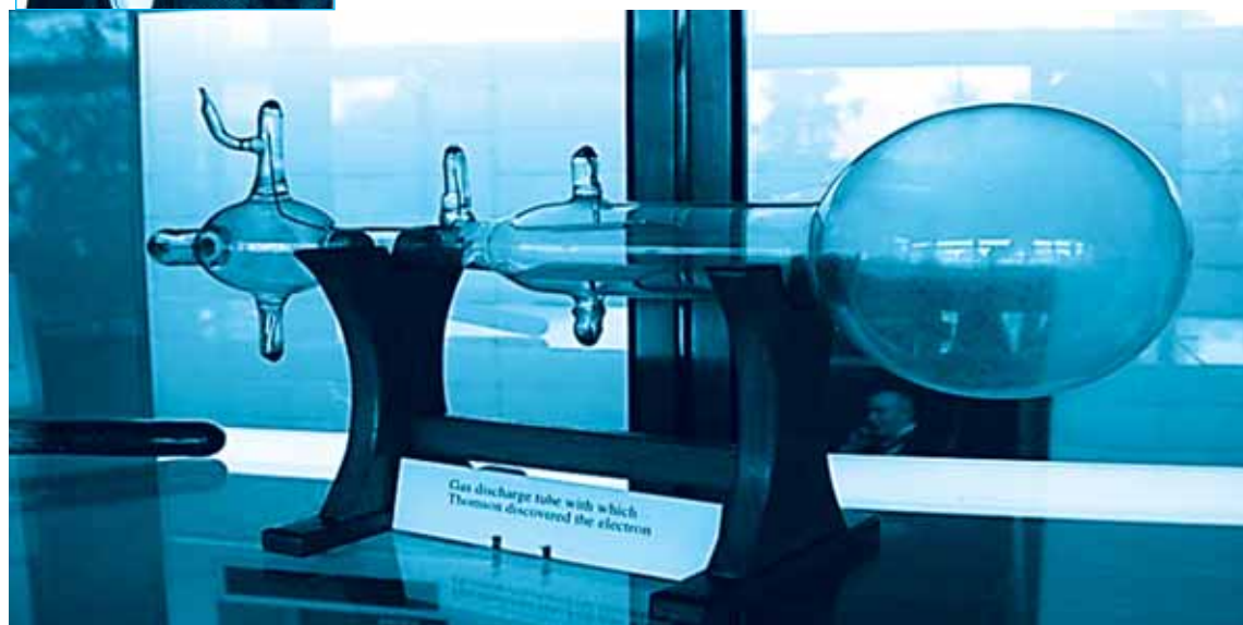
شکل ۱ لوله پرتوی کاتدی که تامسون از آن استفاده کرد. این لوله هم‌اکنون در دانشگاه کمبریج نگهداری می‌شود و در برجسب زیر آن اشاره مستقیمی به نام تامسون به‌عنوان کاشف الکترون شده است.
