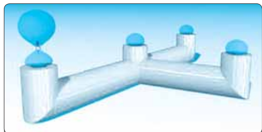
▲ نمایش طرح‌وار یک شیلنگ مغناطیسی. میدان مغناطیسی تولید شده در ورودی شیلنگ به خروجی‌ها منتقل می‌شود.
