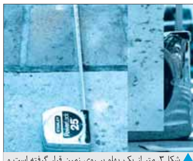
▲ شکل ۳. متر از یک پهلوی روی زمین قرار گرفته است و ساختار فنری آن را به درون بدنه می‌کشد. وقتی نوار کاملاً به درون کشیده شود، چه اتفاقی خواهد افتاد؟
