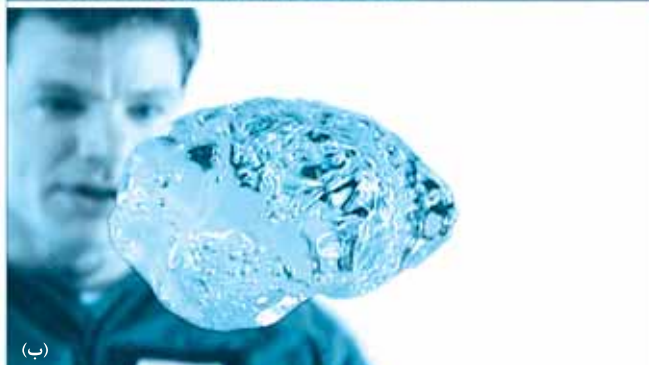
▲ شکل ۴: آزمایش‌هایی با قطره‌های بزرگ آب در شرایط کاهش گرانی در پروازهای سهمی‌وار. (الف) پاشیدن قطرات آب بعد از زدن سوزن به سطح بادکنک و (ب) قطره نوسان‌کننده را نیروی کشش سطحی کنار هم نگه می‌دارد.
