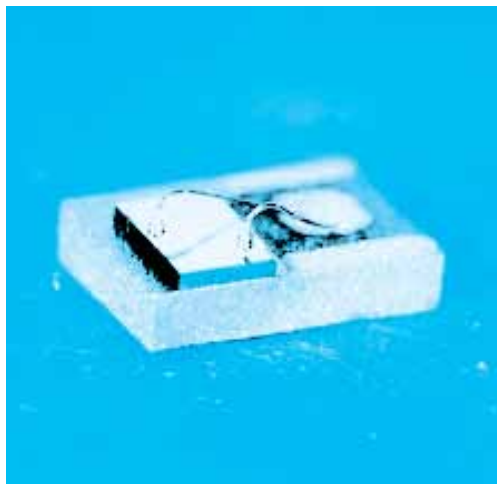
▲ شکل ۱۷. این تراشه ظریف نیمرسانا یک لیزر دیودی است که وقتی جریانی از آن بگذرد باریکه شدیدی از نور همدوس گسیل می‌کند.
