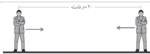
شکل ۹. میکروسکوپ‌های نیروی اتمی قادرند نیروهایی در حدود یک پیکونیوتون را اندازه بگیرند، که تقریباً برابر نیروی گرانشی بین دو شخص متوسط است که حدود ۲۰ متر از هم فاصله داشته باشند.
