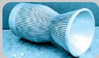
محفظه احتراق سوخت در موشک از آلیاژی شامل نیکل، کروم، آلومینیم و ایتیریم ساخته می‌شود.
