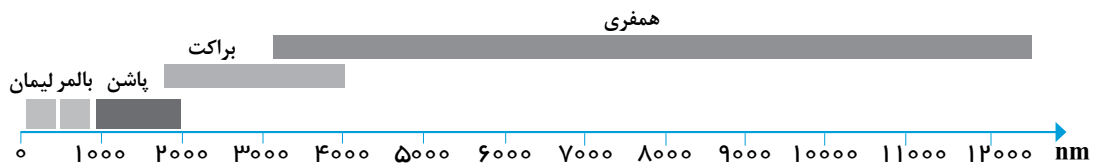
شکل ۲: رسم محدوده رشته‌های طیفی اتم هیدروژن به طور کیفی
