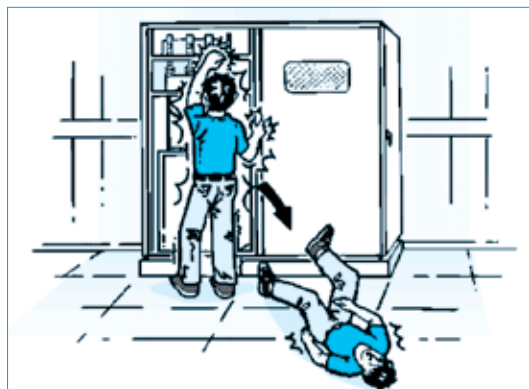
▲ شکل ۲. برق‌گرفتگی و پرت شدن ظاهری که نتیجه واکنش ماهیچه‌های بدن نسبت به رهایی از جریان برق است.
