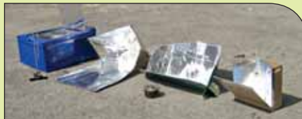
آزمایش عملکرد چند نوع اجاق خورشیدی (شهر قدس ۱۳۸۶)
