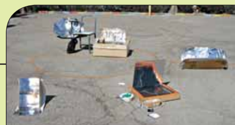
آزمایش عملکرد چند نوع اجاق خورشیدی (شهریار ۱۳۹۰)
