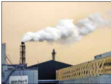
در دودکش سمت راست تمیزکننده خاموش است و در سمت چپی روشن. تفاوت را ببینید.
