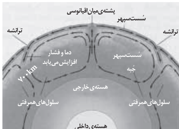
شکل ۳. منظره‌ی ساده‌شده‌ی سلول‌های همرفتی در جبهه‌ی بخش پایین‌رونده‌ی صفحه «تیغه» با افزایش فشار و دما به عمق بیشتر جبهه فرو می‌رود. در عمق حدود ۷۰۰ km، تیغه نرم و جاری شده و در سنگ داغ موجود در سُست‌سپهر ادغام می‌شود.
