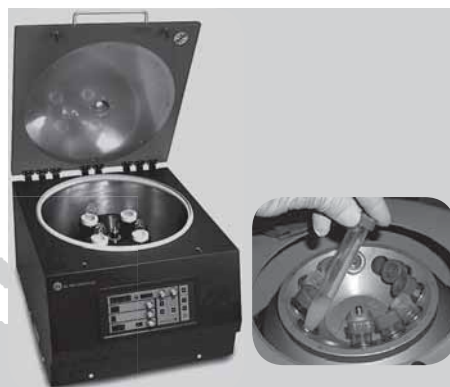
نمای یک سانتریفوژ، دستگاهی که در اثر چرخش و ایجاد نیروی گرانش باعث جداسازی مواد با چگالی‌های مختلف می‌شود.
