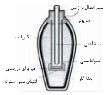
شکل ۱. ساختار درونی باتری ایرانیان
