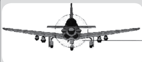
شکل ۷. برای ایجاد تعادل، در طراحی هواپیما از بال‌هایی که رو به بالا زاویه دارند استفاده می‌شود.
