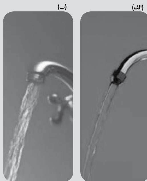
شکل ۶. جریان آب از شیر (الف) در سرعت‌های کم لایه‌ای، اما (ب) در سرعت‌های به حد کافی زیاد متلاطم است.
