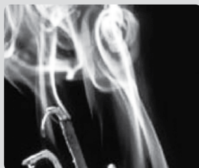
شکل ۳. جریان‌های دود از سرچوب‌های عود تا نقطه‌ی معینی به صورت لایه‌ای بالا می‌روند و سپس متلاطم می‌شوند.
