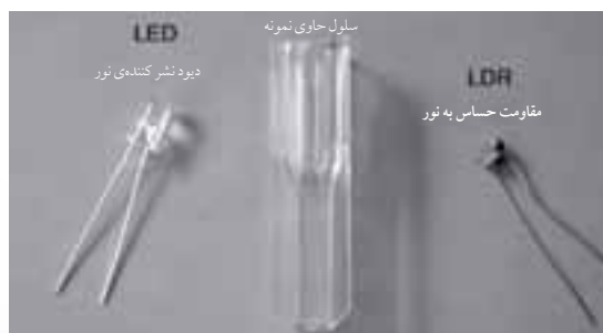
شکل ۱ اجزای ساده ی استفاده شده در ساخت طیف سنج نوری
