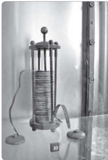
آلساندرو ولتا، در باتری خود صفحه‌هایی از روی و نقره (یا مس) را یکی پس از دیگری روی هم قرار داد و در فاصله میان آن‌ها تکه پارچه‌های خیس گذاشت.
