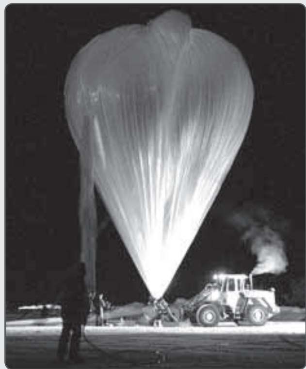
بالونی که مجهز به یک دستگاه طیف‌سنجی IR است و به کمک آن مقدار \text{Cl}_2\text{O} در شمال اسکندیناوی اندازه‌گیری شده است.
