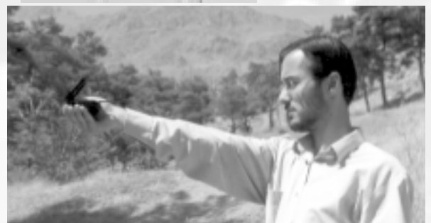
شکل ۳. نشانه روی چشمی برای سوژه‌ی هم ارتفاع
