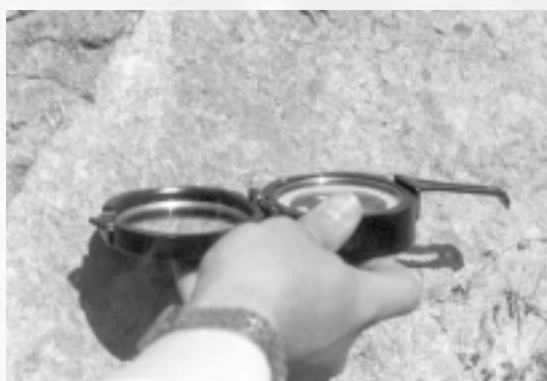
شکل ۵. اندازه گیری موقعیت صفحات به روش مستقیم
