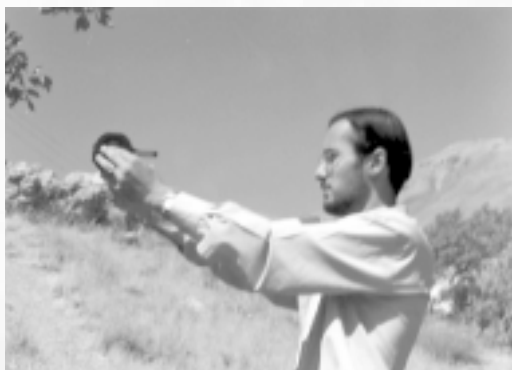
شکل ۸. نشانه‌رویی چشمی برای تعیین ارتفاع نقاط نسبت به خود
