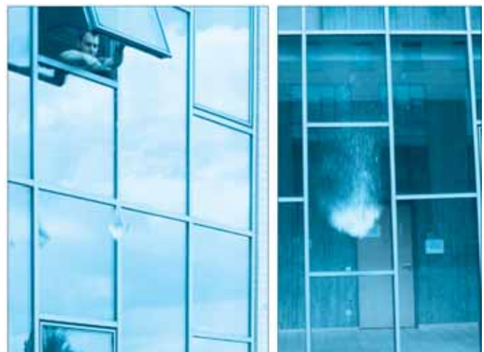
▲ شکل ۲. (الف) سقوط قطره بادکنکی از ارتفاع 8.8 \text{ m} به علت محدودیت قدرت تفکیک فضایی دوربین با سرعت بالا ( 512 \times 512 پیکسل)، تصاویر با یک دوربین دیجیتالی مرتب ثبت می شوند 0.05 \text{ s} و (ب) 1.1 \text{ m} بعد از شروع حرکت.
