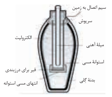
شکل ۱. ساختار درونی باتری ایرانیان
