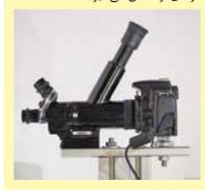
برای عکاسی میکروگرافی به میکروسکوپ یک دوربین نصب شده است.
