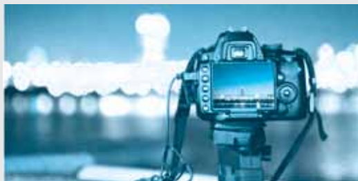
▲ شکل ۲. دوربین‌های عکاسی دیجیتال، نظیر این دوربین، برای گرفتن تصویر به جای فیلم از ابزارهای بار - جفتیده (CCD) استفاده می‌کنند.
