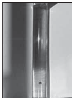
تصویر ۳: تصویر دیجیتالی گلوله در حال سقوط به کمک Tracker
