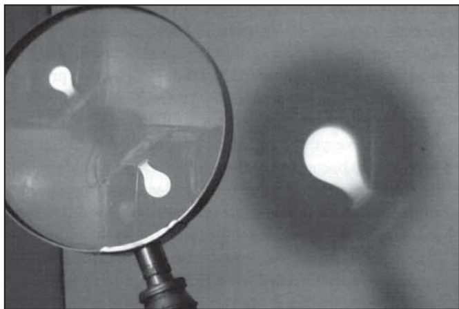
شکل ۲. عدسی همگرا تصویری حقیقی از یک لامپ روشن (تصویر بازتابیده در عدسی دیده می‌شود) را روی دیوار تشکیل می‌دهد.
