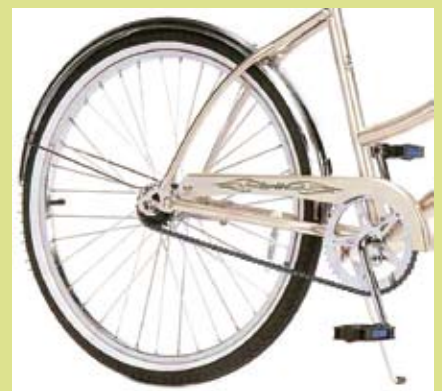
▲ پره‌های دوچرخه به دلیل نحوه‌ی چینش آن‌ها سازه‌های محکمی به وجود می‌آورند.
